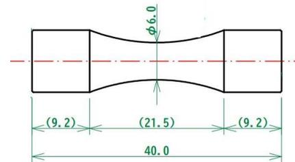
サンプルが小さく所定の試験片が採取できない場合には、当社で考案した短尺試験片での試験も可能です。
